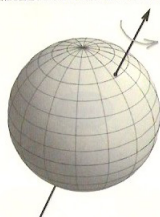
〔図10-3〕 球面の回転を記述するためには角度のほかに回転軸を指定しなければならない
